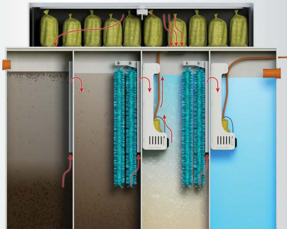
Сточные воды из жилого дома по канализационным трубам самотеком поступают в приёмную камеру №1, где основная часть взвешенных веществ оседает на дно камеры и таким образом задерживается, а незначительная поднимается на поверхность сточных вод.
